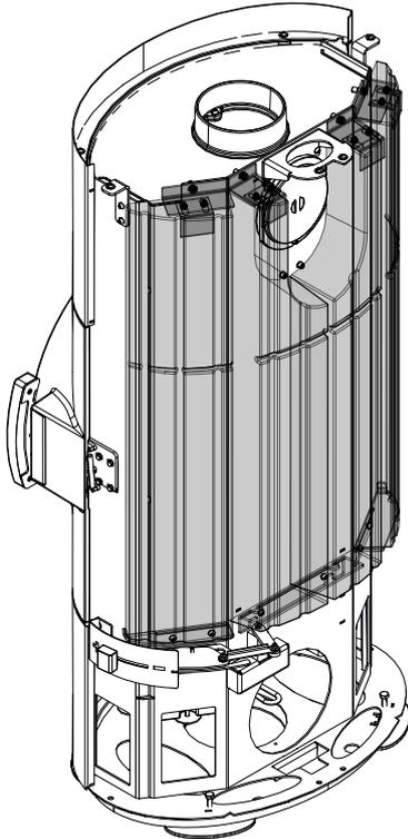
Fig. 42: Svitamento delle viti e smontaggio dell'HMS
