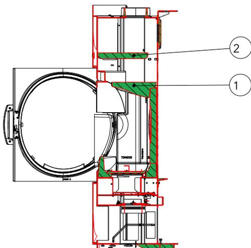
Fig. 40: Rimozione del Keramott e del deflettore
