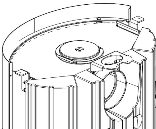
Fig. 14: Coperchio e pezzo di collegamento sostituiti
