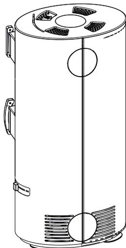
Fig. 10: Collocazione del rivestimento laterale e del coperchio
