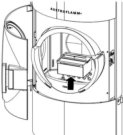
Fig. 35: Rimozione e svuotamento del box cenere
