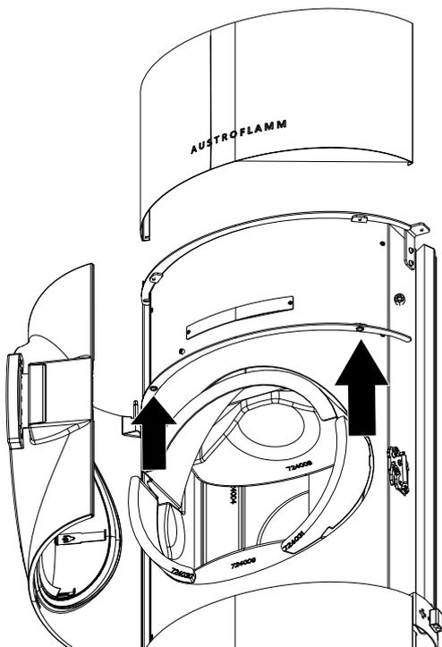
Fig. 21: Smontaggio del rivestimento anteriore superiore
