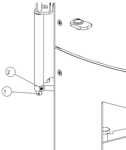
Fig. 28: Regolazione della forza di chiusura dello sportello
