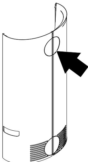
Fig. 11: Rimozione del taglio perforato
