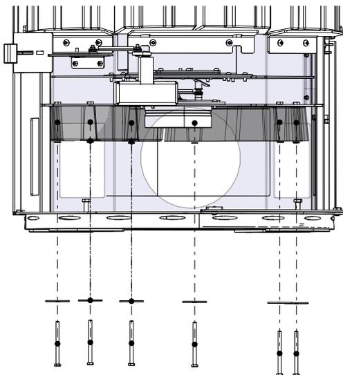
Fig. 8: Montaggio delle pietre HMS dal basso
