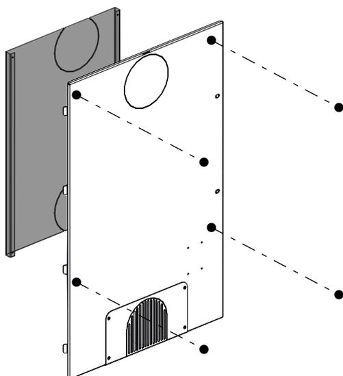
Fig. 12: Smontaggio della protezione anti-irradiazione
