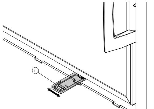
Fig. 31: Regolatore dell'aria primaria/secondaria
