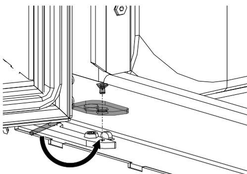
Fig. 26: Agganciamento dello sportello e tensionamento della molla
