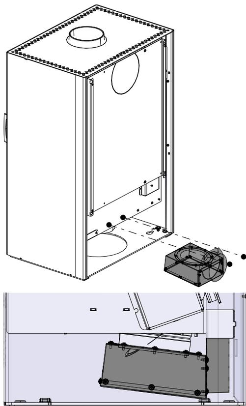
Fig. 11: Montaggio dell'adattatore dell'aria di alimentazione
