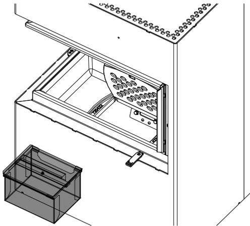
Fig. 38: Rimozione e svuotamento del box cenere
