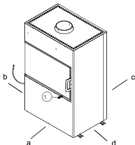
Fig. 3: Distanze di sicurezza (a,b,c) / regolatore dell'aria
