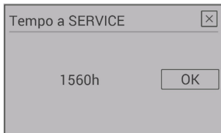
Fig. 71: Intervallo di tempo senza manutenzioni scaduto
